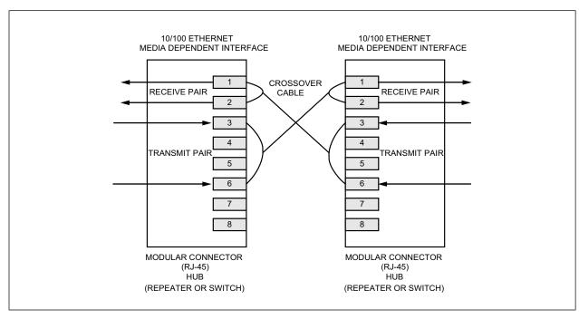
FIGURE 3-6: TYPICAL CROSSOVER CABLE CONNECTION
