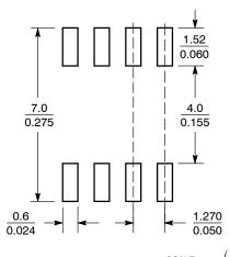
$\left(\frac{\text{mm}}{\text{inches}}\right)$ SCALE 6:1
