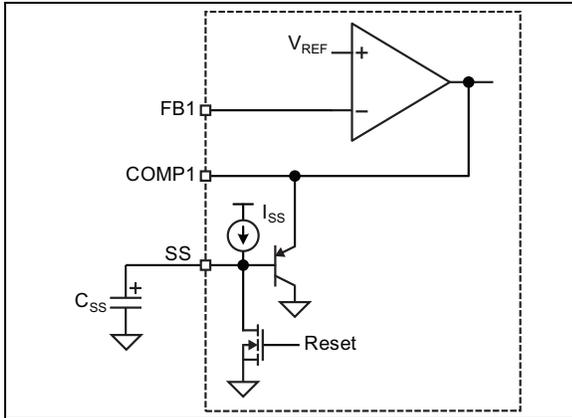
**FIGURE 4-3:** Soft-Start Circuit.
