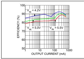
**FIGURE 2-1:** Efficiency ( $V_{OUT} = 3.3V$ ).
